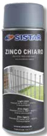
Zincante galvanizzante a freddo di colore grigio chiaro/alluminio semi lucido. Altamente protettivo grazie alla polvere di zinco pura al 98%, produce un rivestimento finale di elevata durezza. Resistente alla temperatura fino a 400°C. Essiccazione fuori polvere 10' a 20°C, sopra verniciabile se necessario dopo 12 ore.
