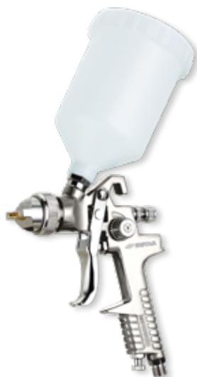
Pistola a spruzzo a gravità con tecnologia HVLP per carrozzeria di autoriparazione. Corpo cromato per prodotti vernicianti sia a solvente che a base acqua. Cappello aria, ago e ugello in acciaio inox. Ampia disponibilità di ugelli per ogni esigenza.
